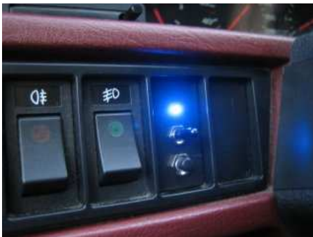
Bild på manöverpanel i en Volvo med lysdiod, trevägsströmbrytare samt tryckknapp
